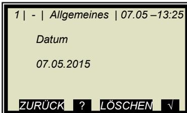
Mit **LÖSCHEN** wird der Eintrag gelöscht und anschließend das neue Datum eingegeben. Das geänderte Datum wird mit  bestätigt und gespeichert.
