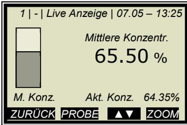
Nach Abschluss der Probenahme werden während der Eingabe der Laborwerte die einzelnen Proben, in Abhängigkeit des eingestellten Splitwertes, aktiviert oder deaktiviert. Alle Proben kleiner oder gleich dem Splitwert werden dem unteren Konzentrationsbereich zugeordnet und alle Proben oberhalb dem oberen Konzentrationsbereich.
