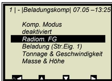
Für den Regelfall einer Kompensation mit der radiometrischen Flächengewichtsmessung, wählen Sie:
