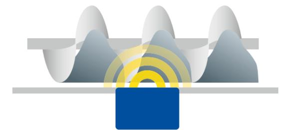
Einbau in einer Förderschnecke
