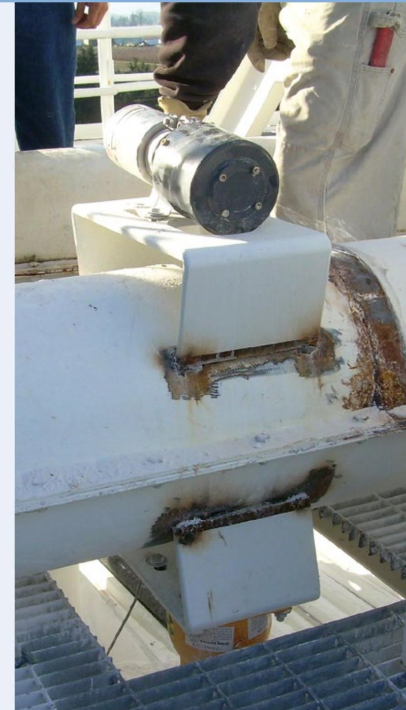
Mengenmessung an einem Schneckenförderer
