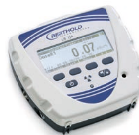
Abbildung 1: LB 134 UMo II Basiseinheit. Die Software bietet zahlreiche Messmodi und Parametereinstellungen.
