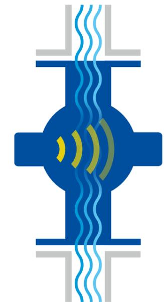
Schematische Darstellung einer Wasser-/Trockengehaltsmessung an einer Rohrleitung mit FlowCell
