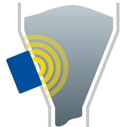
Einbau im Schacht oder Silo mit Resonator
