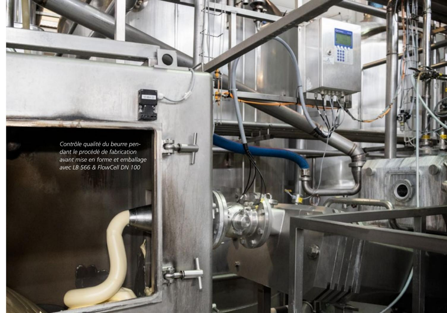
Contrôle qualité du beurre pendant le procédé de fabrication avant mise en forme et emballage avec LB 566 & FlowCell DN 100
