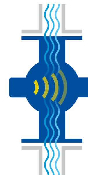
Représentation schématique d'une mesure de la teneur en eau/solides sur un tuyauterie avec une FlowCell
