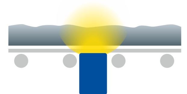
Mesure d'humidité avec une sonde surfacique sur un transporteur
