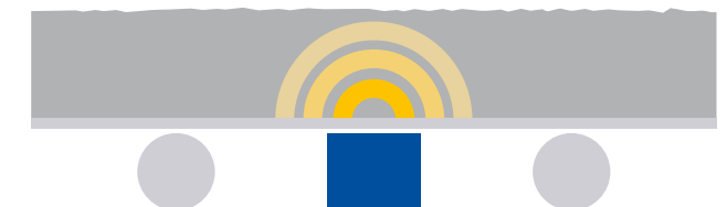
Représentation schématique de la mesure de l'humidité neutronique sur une bande transporteuse
