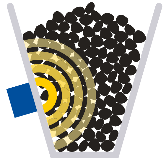
Représentation schématique de la mesure de l'humidité neutronique dans une cuve
