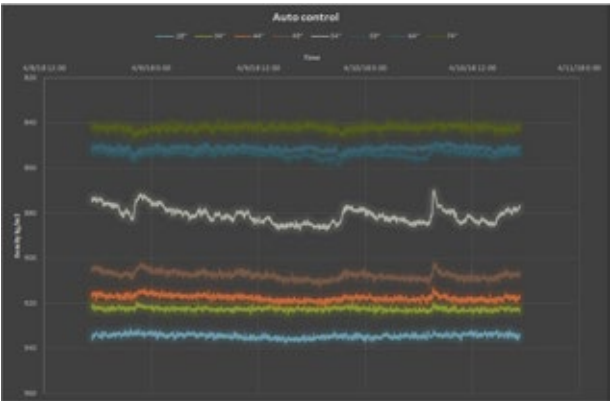
Fig. 10 Courbes de densité types avec un réglage automatique de la sortie d’eau
