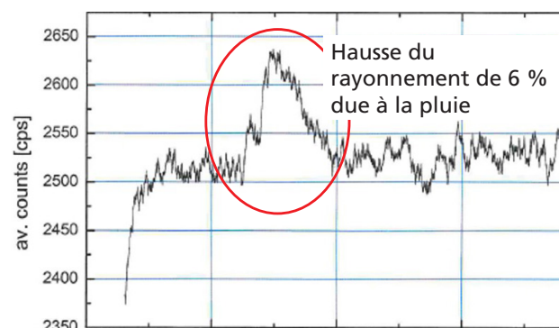
Fig. 7 Fluctuation du rayonnement du bruit de fond (mesuré à Bad Wildbad, en Allemagne) due à la pluie
