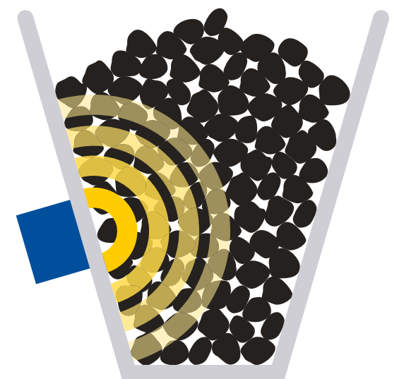
Representação ilustrativa da medição por nêutrons da umidade no silo
