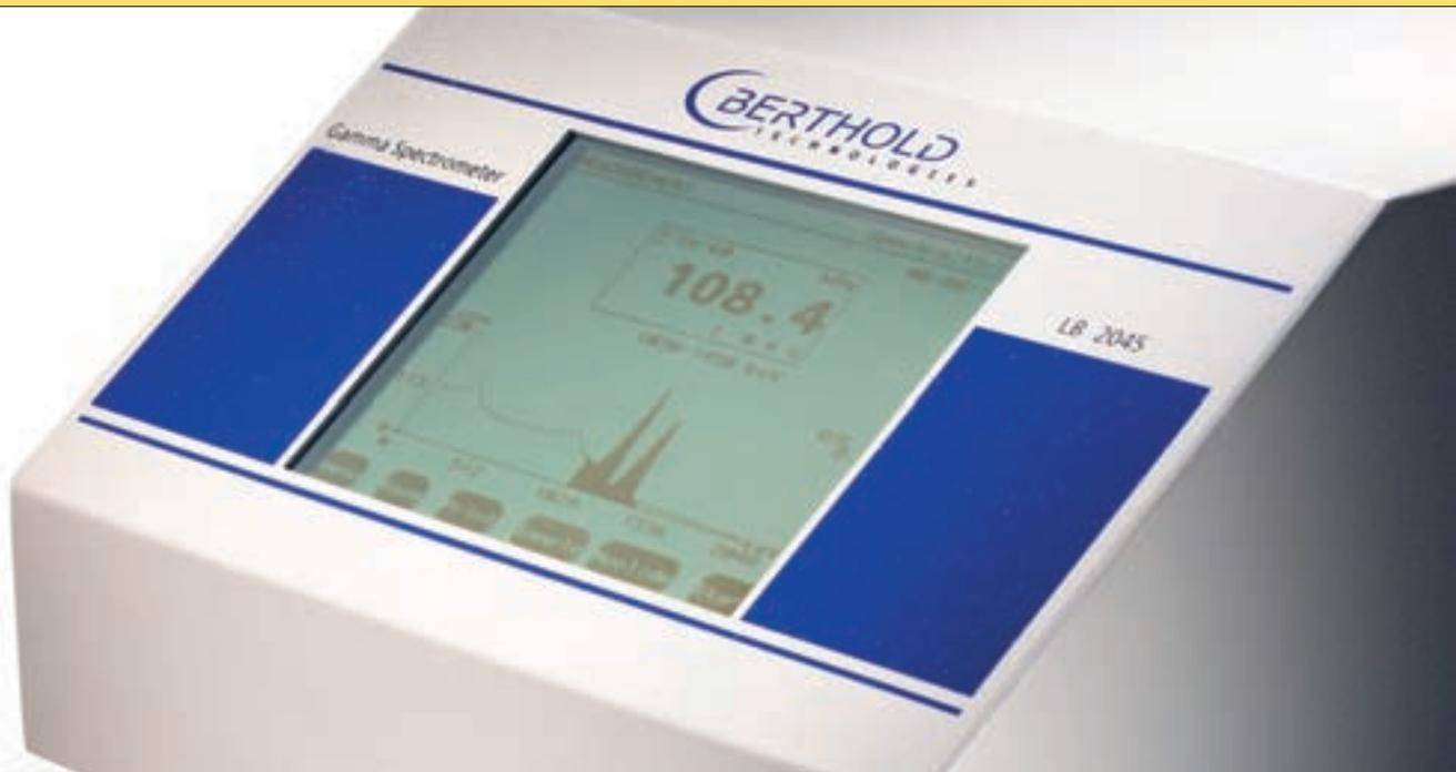
Der LB 2045 ist ein moderner Labor-messplatz zur Aktivitätsmessung mittels Gamma-Spektroskopie. Er ist einfach und leicht zu bedienen und liefert rasch und zuverlässig Messergebnisse, die auf einem großen
