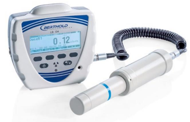
Portable Kombination des LB 134 UMo II mit der LB 1236-H10 Gammasonde.
