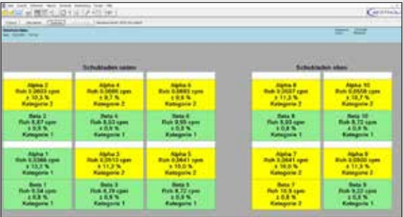
LB 790 AMS Anzeige der Messwerte für alle 10 Detektoren und beide Kanäle
