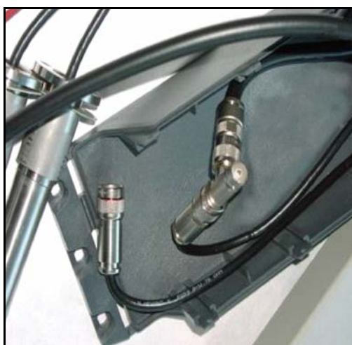
HV-Teiler, nur ein einzelner Detektor ist angeschlossen (siehe auch Abbildung auf Seite 100).
