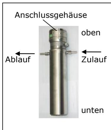
Wird der Detektor senkrecht montiert, dann muss das Anschlussgehäuse nach oben ausgerichtet sein, damit die Anschlussstutzen am oberen Ende der Wasserkühlung sind.
