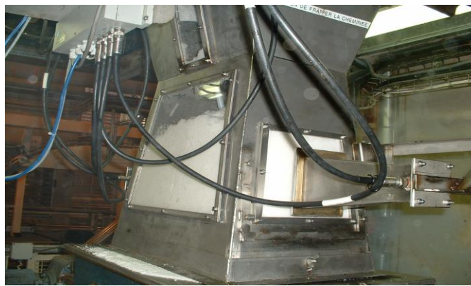
Fig. 5 – Medición de la humedad del azúcar
